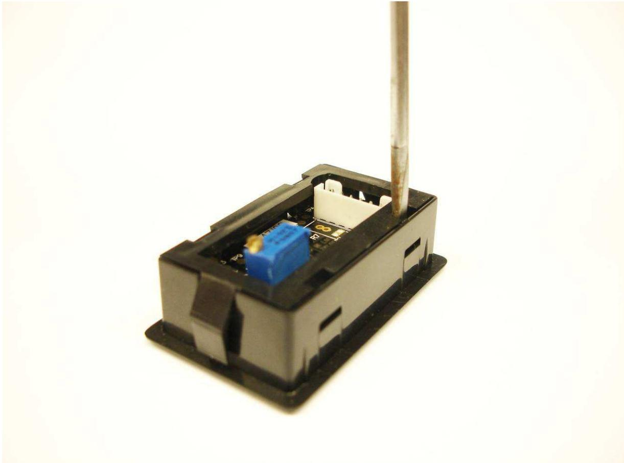
Mit einem kleinen Schlitzschraubendreher vorsichtig die Schnappverschlüsse lösen
